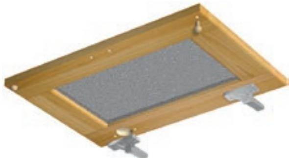
Забивка петель и амортизаторов.
